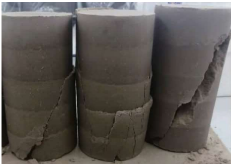
图 3 三轴压坏试件
