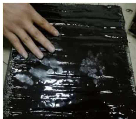
图 2 试验室常温 1 d 后试件表干图
