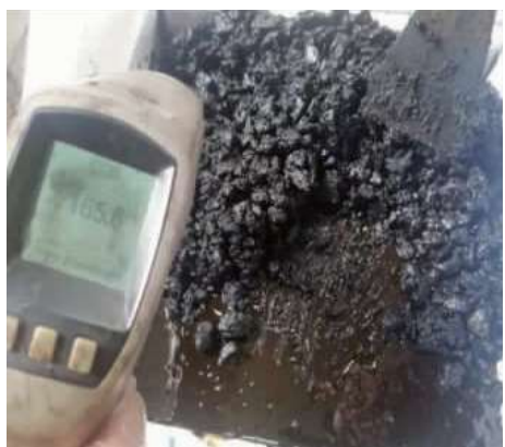
图 3 被 SMA 再次加热后呈熔融状态图
