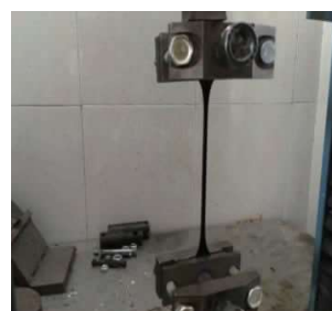
(a)胶膜拉伸试验照片
