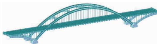
图 4 加固桥梁有限元模型
