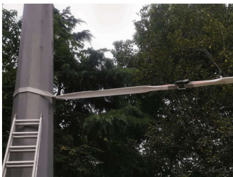
图7 采用水平拉力加载杆体
