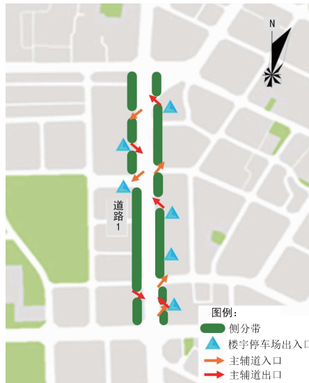
图6 道路1侧分带出入口优化
