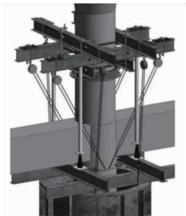
图 3 压入钢套箱加固桩基础技术原理
