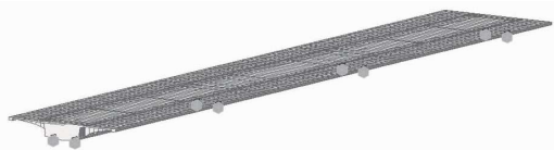
图3 Midas 空间杆系有限元模型
