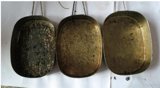
图 1 隔离剂使用效果(从左至右:空白组,菜油组,HZ 隔离剂组)
