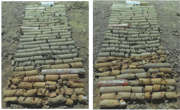
图 2 抽检桩芯样照片
