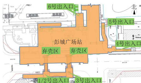
图9 彭城广场站矩形顶管平面示意图
