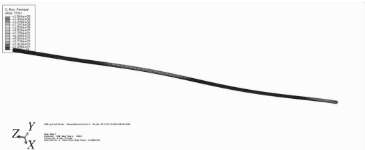
图 5 12 m 水深管道最大应力图
