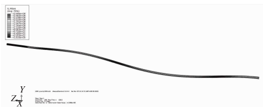
图7 15 m水深管道最大应力
