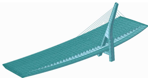
图1 光谷八路桥主桥有限元模型
