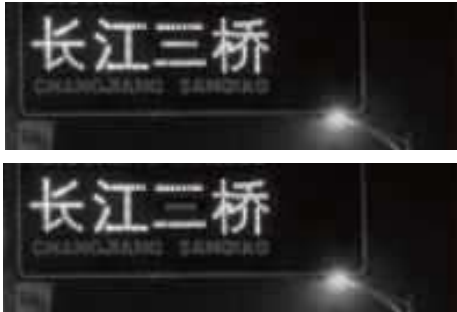
图 4 点阵式主动发光标志损坏
