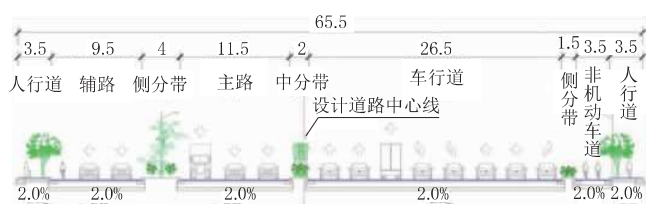
图 9 标准横断面设计图(平交口路段)(单位:m)
