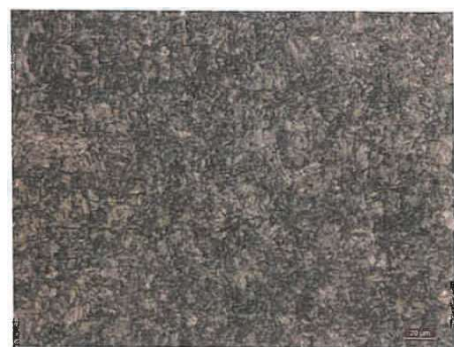
图4 典型高强度螺栓断口金相图谱
