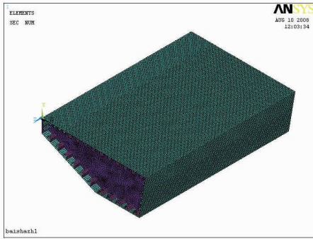
图6 钢箱梁局部有限元模型
