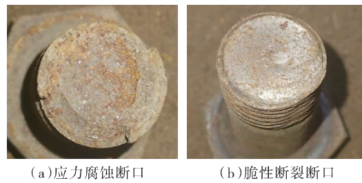
图3 典型高强度螺栓断口
