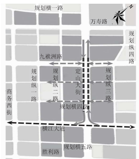
图4 “一线六联络”树形方案平面示意图
