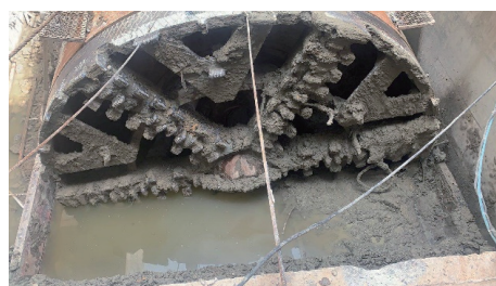
图 9 盾构接收后刀盘现状
