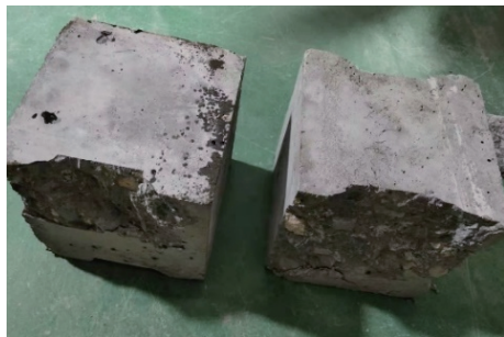
图 7 外置注浆盒保护刀切削后的混凝土试块
