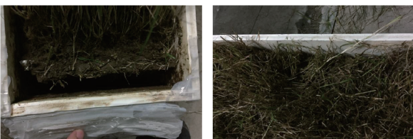
(a)上游端脱离箱体 (b)前半部分冲刷明显
