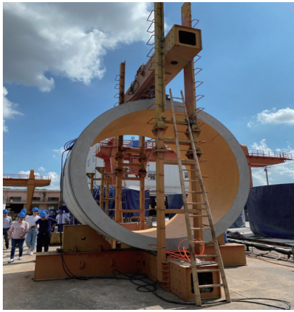
图4 三边支承法外压荷载试验
