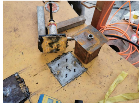
图3 锚固键从混凝土中拔出
