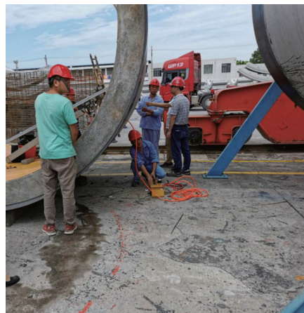
图8 内衬抗外水压试验
