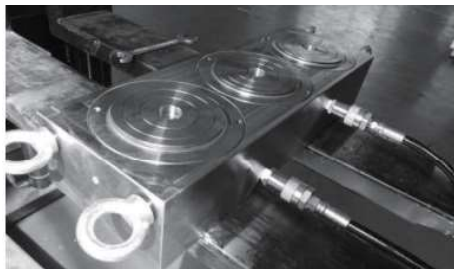
图6 500 t三连杆超薄液压千斤顶
