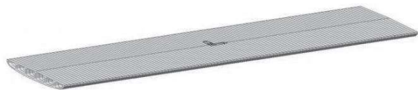
图1 整体式道路单墩顶升计算模型
