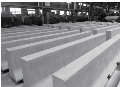
图7 周家嘴项目全预制构件生产图
