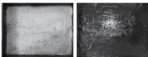
(a)黄土污染 (b)机油污染 图3 层间污染方式对比
