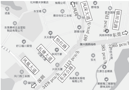
图 1 深圳 - 东莞方向交通量分布图(单位:pcu/h)
