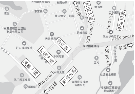
图 2 东莞 - 深圳方向交通量分布图(单位:pcu/h)
