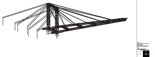
图 10 桐庐悬廊桥成桥失稳图(横向失稳)
