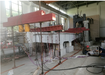
图 4 \pi 形整体浇筑断面 UHPC 盖梁试验
