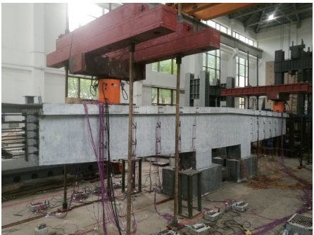
图 5 口形分层浇筑断面 UHPC 盖梁试验
