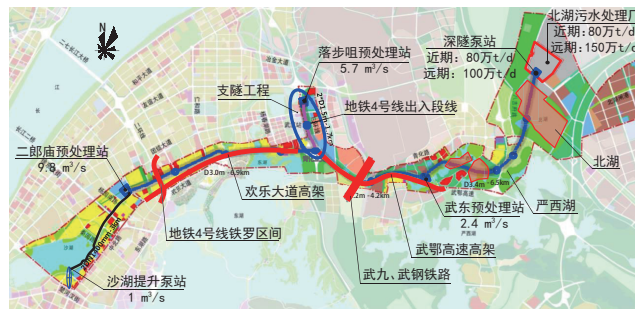
图 1 东湖污水管道深隧工程平面设计图
