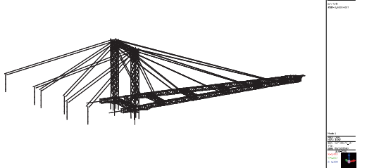
图 10 桐庐悬廊桥成桥失稳图(横向失稳)
