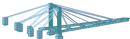
图2 桐庐悬廊桥整体杆系模型示意图
