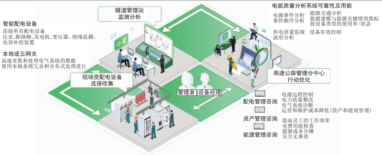
图3 隧道智能配电系统架构方案
