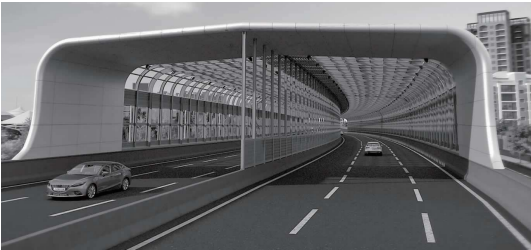
图 1 全封闭声屏障典型断面
