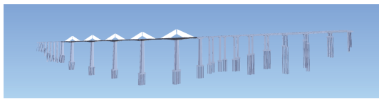
图 2 多塔斜拉桥 BIM 模型
