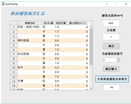
图 5 桥面铺装病害评定
