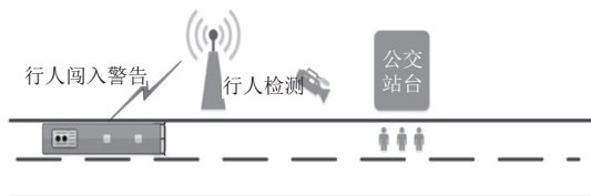
图 3 V2X 站台占用检测系统示意图
