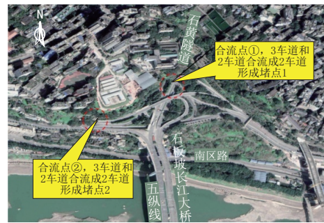
图8 石板坡立交匝道示意图
