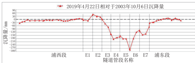
图4 隧道南孔各区间结构累计沉降分布
