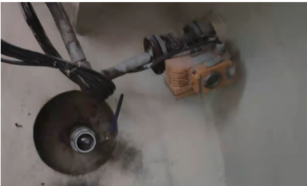
图 5 铰接油缸上增加油压传感器
