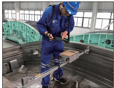
图 4 钢模激光测量现场照片
