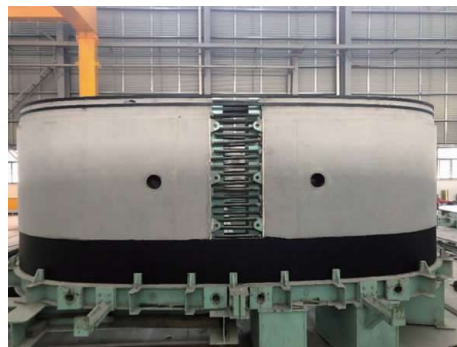
图4 端板难以拆除
