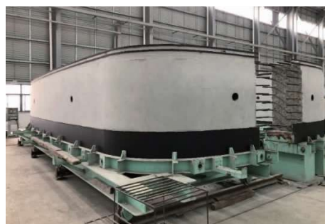
图4 端板难以拆除
