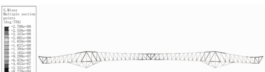
图 8 (自重 + 降温 10℃)结构 Mises 应力分布图(单位:Pa)
