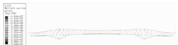
图 5 整体升温 10℃截面正应力分布示意图(单位:Pa)
