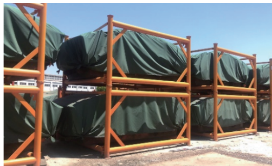
图 7 钢模长期堆放钢结构架
