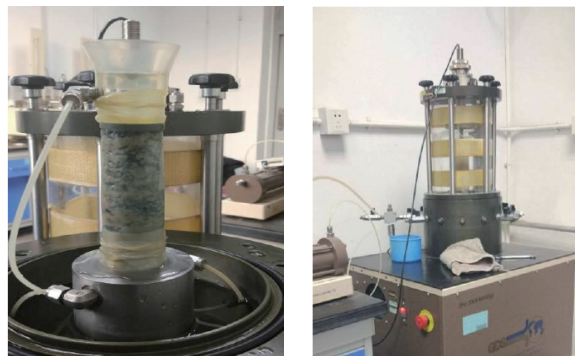
图1 动三轴仪对混合砂试样施压过程
