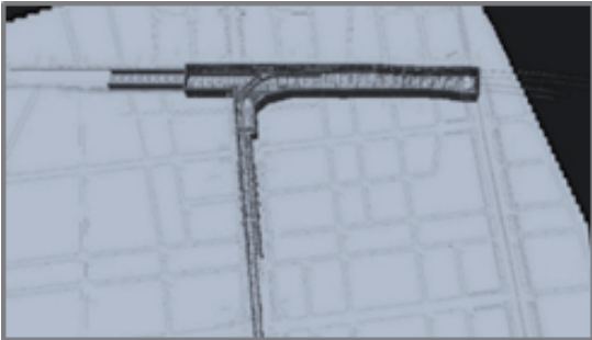
图 13 地连墙三维立体概化图
