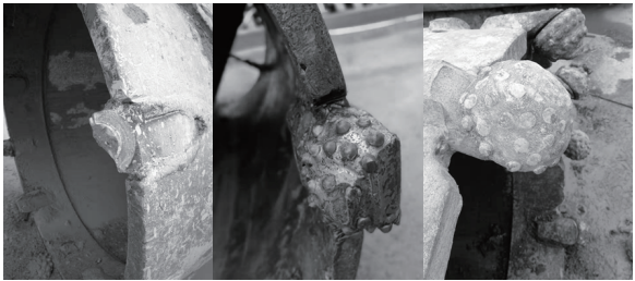
图 8 牙轮状况图 (a)断裂式 (b)单边磨损式 (c)均匀磨损式
