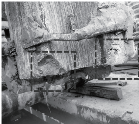
图2 锤牙破损的锤头图
