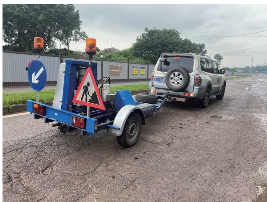
图2 旧路 FWD 测试现场之实景
