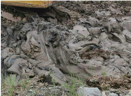
图 5 淤泥质土整体成流塑状之实景
