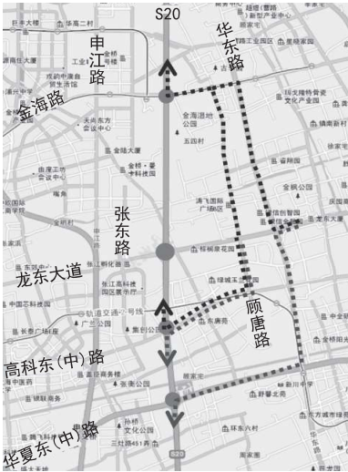
图14 进外环车辆施工期间交通组织(2)
