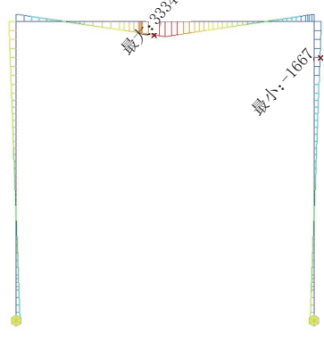
图 5 输入刚度模型弯矩图(单位:kN·m)
