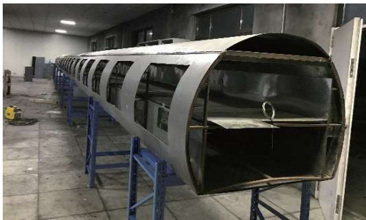
图 8 隧道缩尺模型(1:15)之实景
