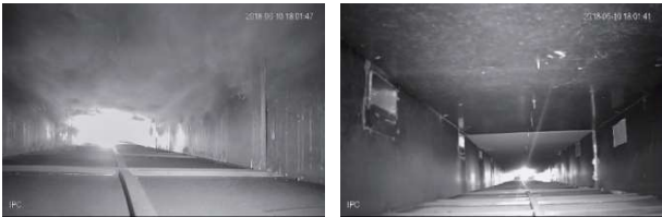
图 11 点火后 78 s(实际火灾发展 5 min)试验结果图示
