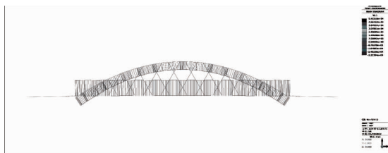
图 8 恒载作用 主梁主拱轴力图 (单位: kN)
