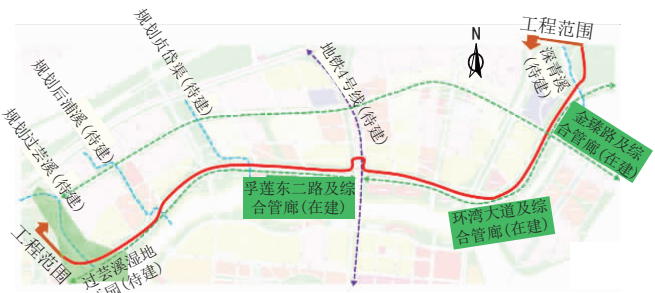
图 7 主干渠与综合管廊关系图
