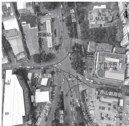
图5 现状交叉口冲突点示意图
