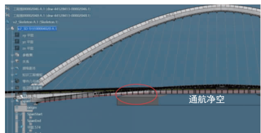
图 12 副拱通航净空检查
